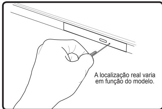
A ejecção de emergência está situada num orifício na unidade óptica e é utilizado para ejectar o suporte da unidade óptica caso a ejecção electrónica não funcione. Não utilize a ejecção de emergência em vez da ejecção electrónica.
